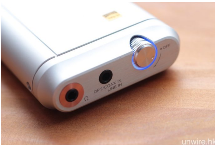
嵌入式音量調校旋鈕設有藍色 LED 標示燈，而 3.5mm 輸出端子則為四極設計，左右聲道設有獨立接地，同時設有 3.5mm Line/光纖/同軸輸入端子。
